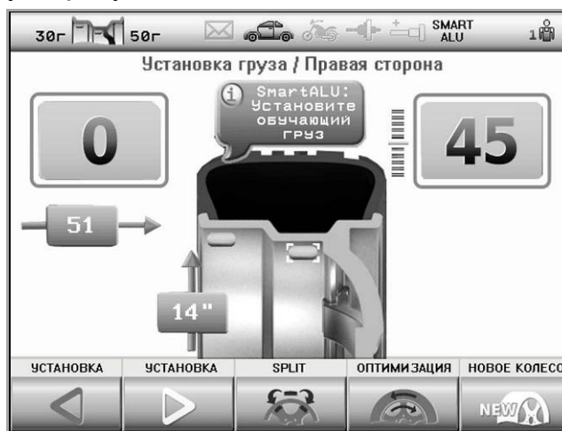
а – схемы, при которых работает SmartALU б – экран запроса обучающего груза
