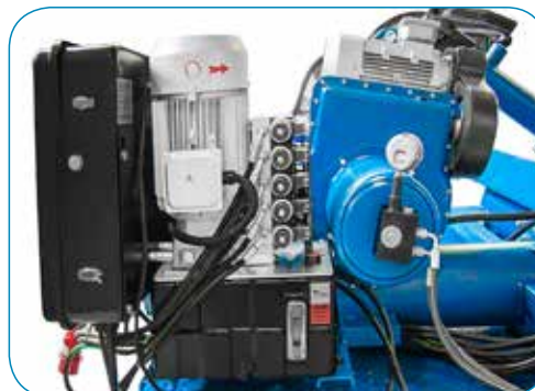
Усиленная гидравлическая станция
