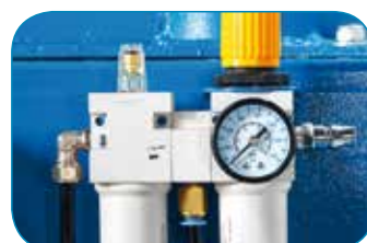
Блок подготовки воздуха
