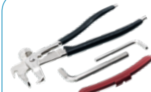
Эталонный грузик, шестигранный ключ, клещи для установки и снятия грузиков
