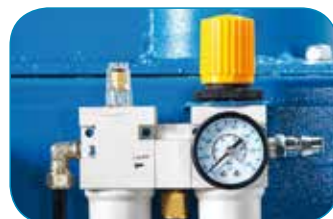
Блок подготовки воздуха
