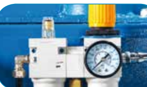
Блок подготовки воздуха
