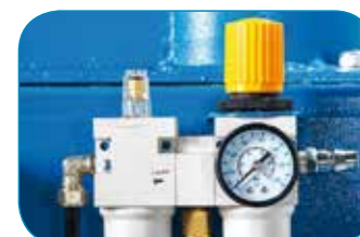
Блок подготовки воздуха
